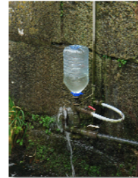
Le bélier expérimental du Pavillon de Manse, à Chantilly.
